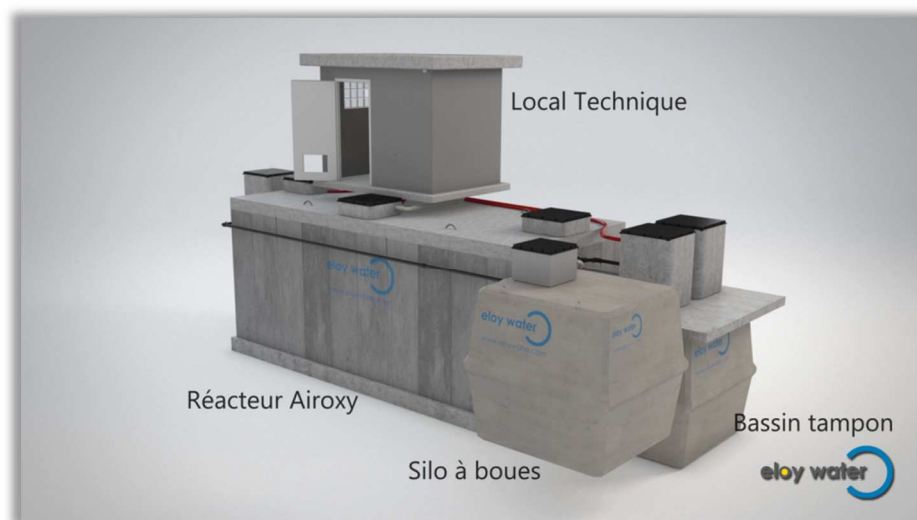
Figure 8 : Vue 3D d'une filière classique Airoxy
