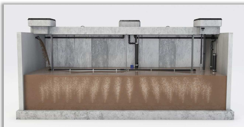
Figure 3 : SBR - Phase de remplissage
