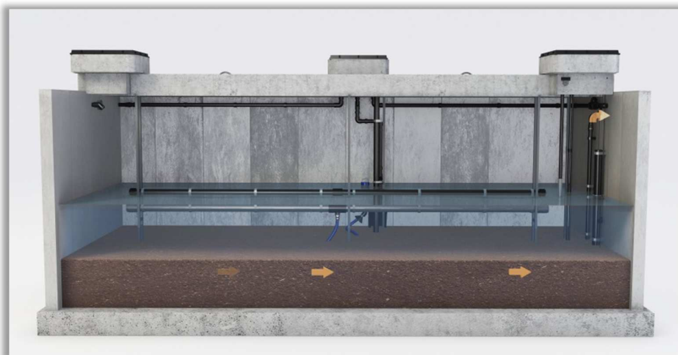
Figure 6 : SBR - Phase de purge des boues
